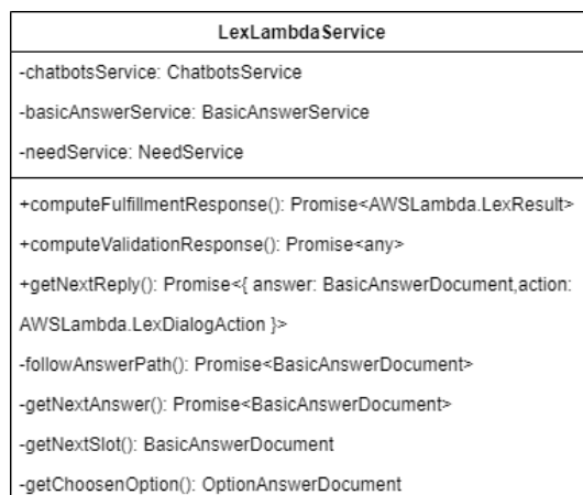
Figura 7.4: Struttura della classe LexLambdaService , responsabile della gestione della logica di calcolo della risposta.
